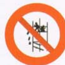
Ponteggio, gettare oggetti, Divieto ★★
